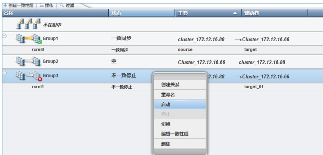
图 177：启动全局镜像数据同步
