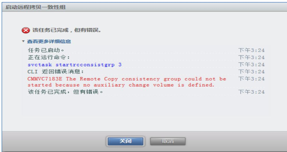
图 187：启动具有变更卷的远程拷贝关系的一致性组失败
