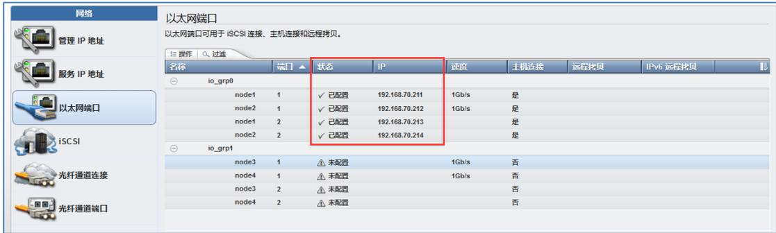
图 41：完成以太网端口 IP 地址配置
