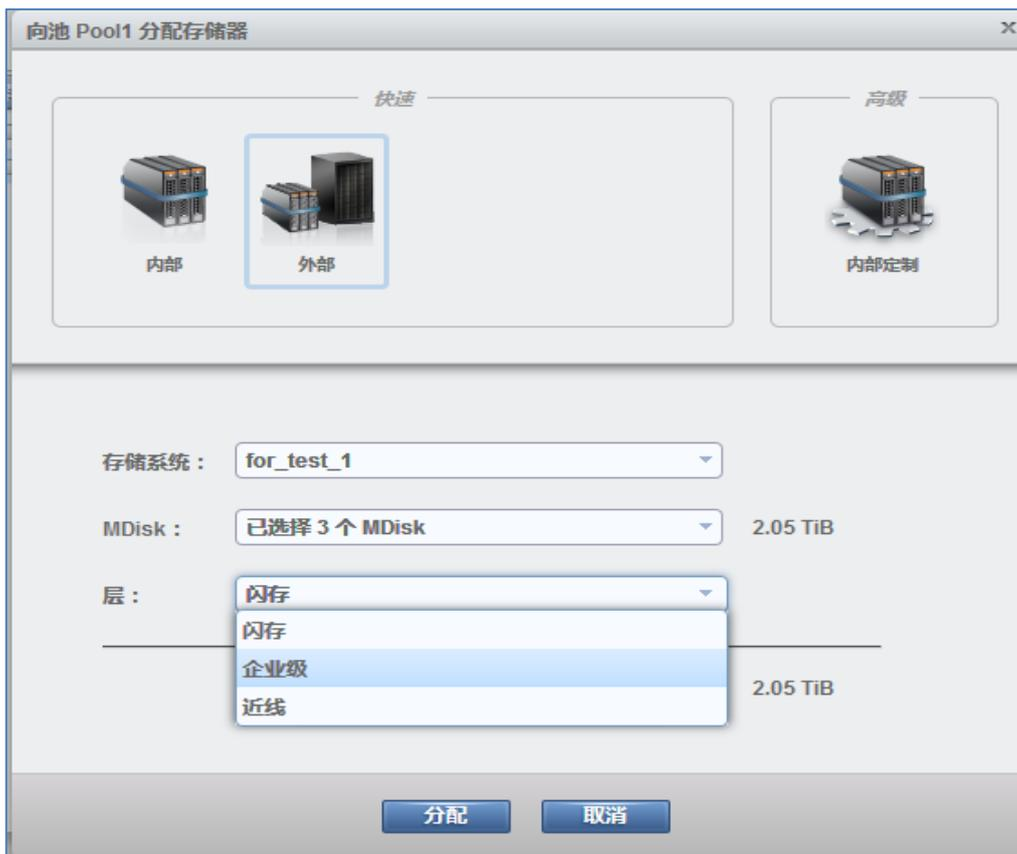
图 70：设定外部存储设备的存储层
