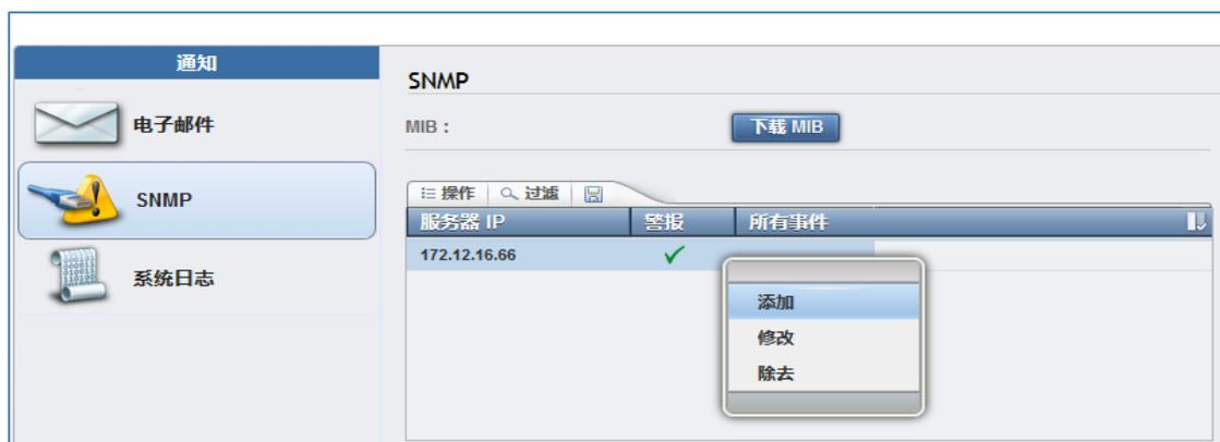
图 21: 修改 SNMP 服务器设置
