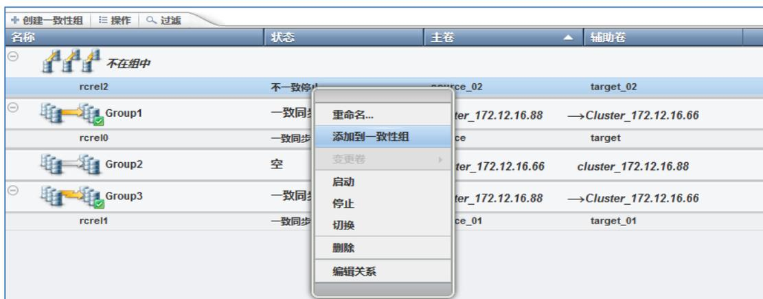
图 184：将具有变更卷的远程拷贝关系添加到一致性组中
