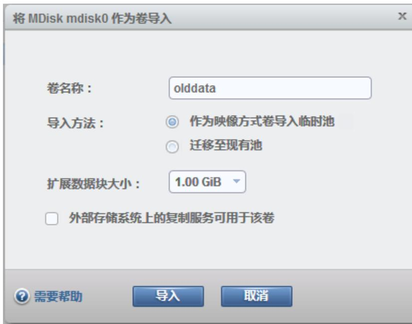
图 75：导入外部存储器参数设置
