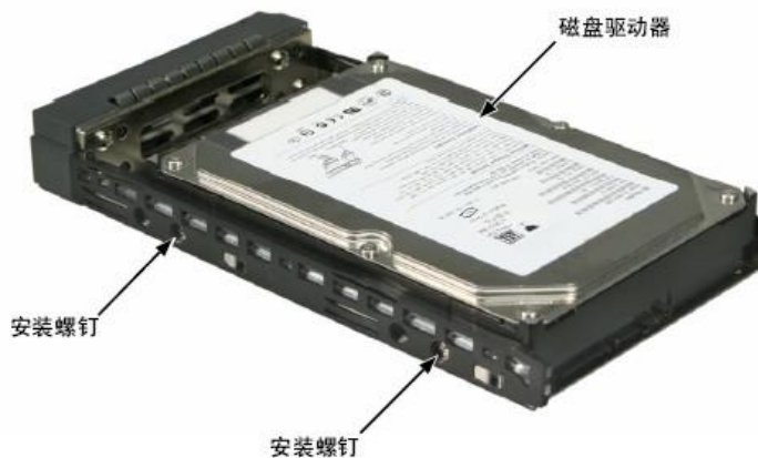
图 6. 安装在驱动器外壳中的磁盘驱动器
