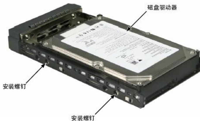
图 6. 安装在驱动器外壳中的磁盘驱动器
